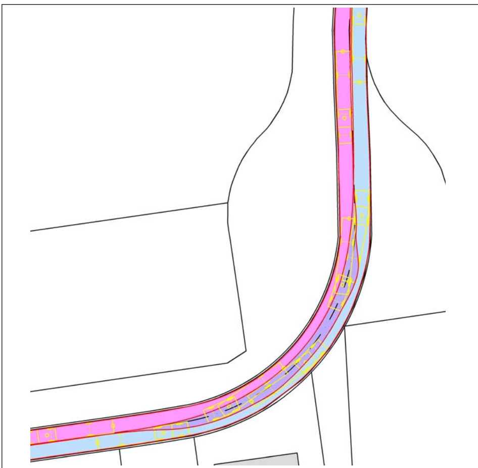
Bild 27: Schleppkurve Begegnungsfall Lkw / Lkw Bestand
