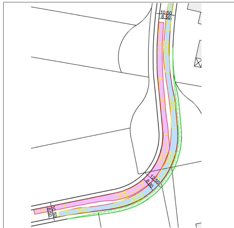
Bild 28: Schleppkurve Begegnungsfall Lkw / Lkw Planung
