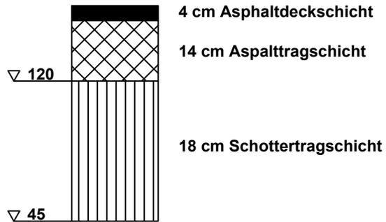
In stark belasteten Fahrspuren, wie z.B. Busspuren oder Stauräumen vor Kreuzungen sind Sonderbauweisen erforderlich ( Abstimmung mit dem SG 4.2 - Tiefbau, Verkehrslenkung und Grün )erforderlich!)
